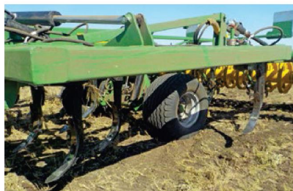
Рабочие органы: двухрядная дисковая секция, стойки чизельные, диски заравнивающие, катки опорные
